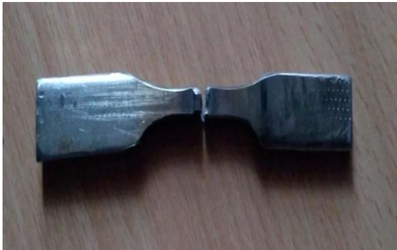
Fig. 4. Tensile test specimen.
